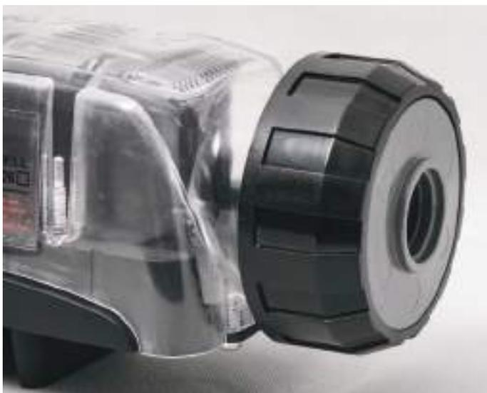
3. Prenda a Célula numa posição vertical com o bujão cego na parte inferior; para reter eventuais derrames, a Célula deve ser posicionada num contentor à prova de ácido.
