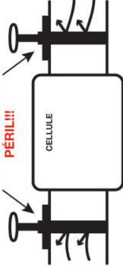
Les vannes de la cellule doivent être **OUVERTES** quand l'électrolyse fonctionne
