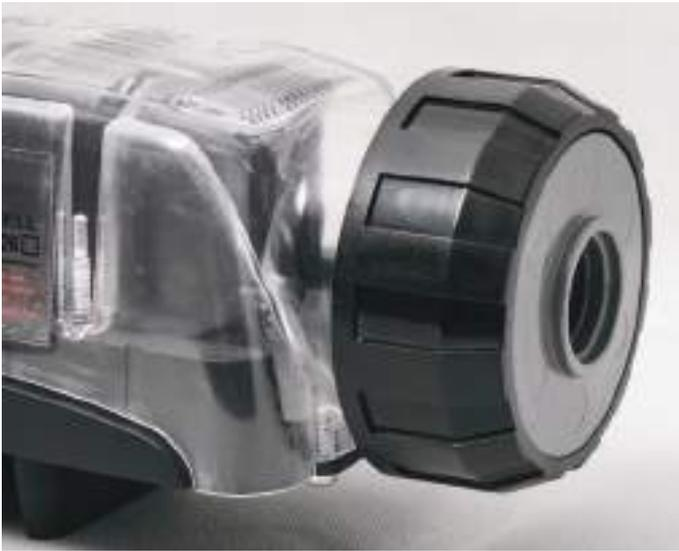
3. Installer la cellule en position verticale, bouchon d'obturation vers le bas. Pour éviter toute projection d'acide, la cellule doit être placée dans un récipient résistant à l'acide.
