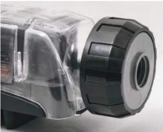
3. Asegure la célula en posición vertical con el tapón ciego en la parte inferior; con el fin de recoger cualquier posible material vertido, la célula debe estar en un recipiente resistente a los ácidos.
