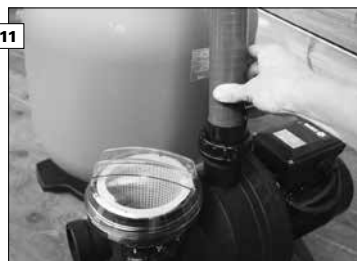
11 Vissez les raccords dans le filtre et la pompe. Glissez les manchons, puis les rallonges sur les deux extrémités du flexible. Repoussez les rallonges dans le raccord et vissez les manchons. (voir partie technique : 2.4.3 Raccordements).
