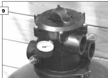
9 Dévissez ensuite le petit clapet sur le côté de la vanne et placez-y le manomètre.
