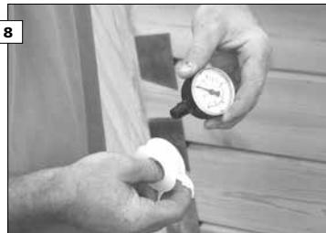
8 Apposez du téflon sur le filetage extérieur du manomètre.
