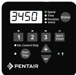
Abbildung 12: Festlegen der Drehzahl für die Schnellreinigung
