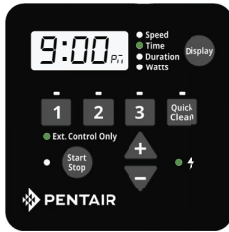
Abbildung 7: Ausschließlich externe Steuerung aktivieren
