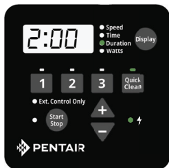
Figure 13 : Réglage de la durée de Quick Clean
