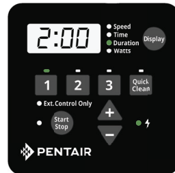
Figura 10: Ajuste de la duración
