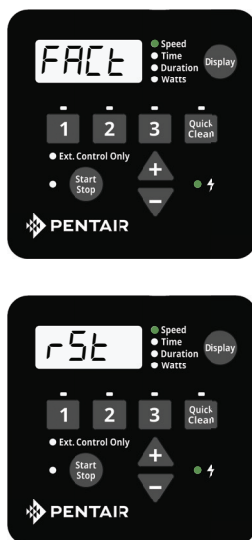
Figura 14: ripristino delle impostazioni di fabbrica del convertitore
