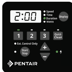
Figure 10 : Réglage de la durée
