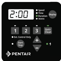
Abbildung 13: Festlegen der Dauer für die Schnellreinigung
