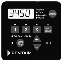
Figure 12 : Réglage de la vitesse de Quick Clean
