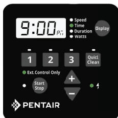
Figure 7 : Activation du mode Commande externe uniquement
